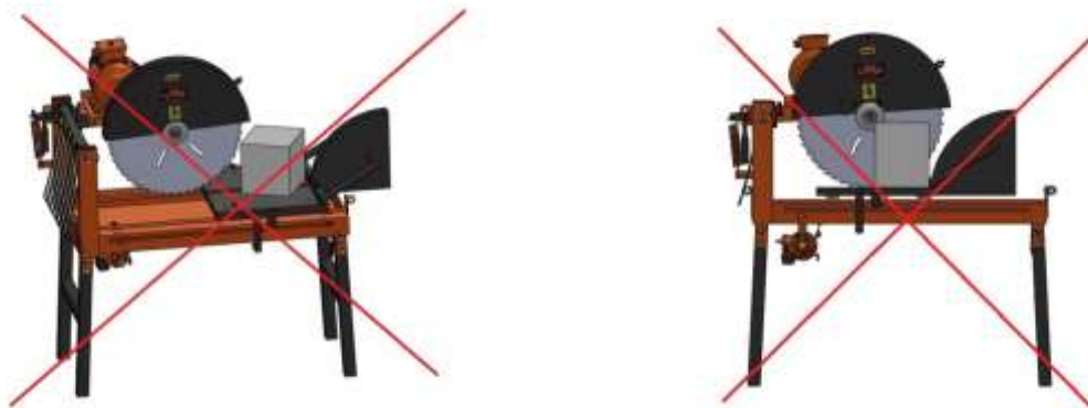
Рисунок 6-а: Неверное расположение материала на столе Рисунок 6-б: Обработка чрезмерно большого блока
